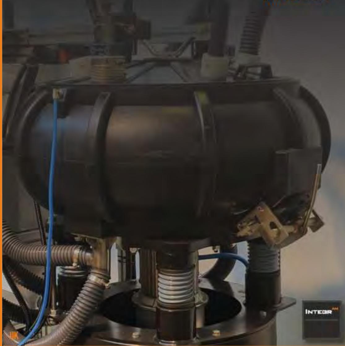
La technologie SUPER VibroBLAST S-VBA-DP combine tous les avantages de la technologie standard VirboBLAST VBA-DP avec des bols spécialement conçus, équipés d'un système d'évacuation des grenailles de sablage augmenté (jusqu'à trois fois) et d'un système d'aspiration et de filtration plus puissant (jusqu'à environ 3 fois).
