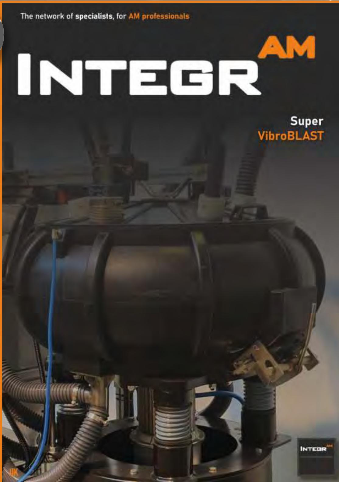
La technologie SUPER VibroBLAST S-VBA-DP combine tous les avantages de la technologie standard VirboBLAST VBA-DP avec des bols spécialement conçus, équipés d'un système d'évacuation des grenailles de sablage augmenté (jusqu'à trois fois) et d'un système d'aspiration et de filtration plus puissant (jusqu'à environ 3 fois).
