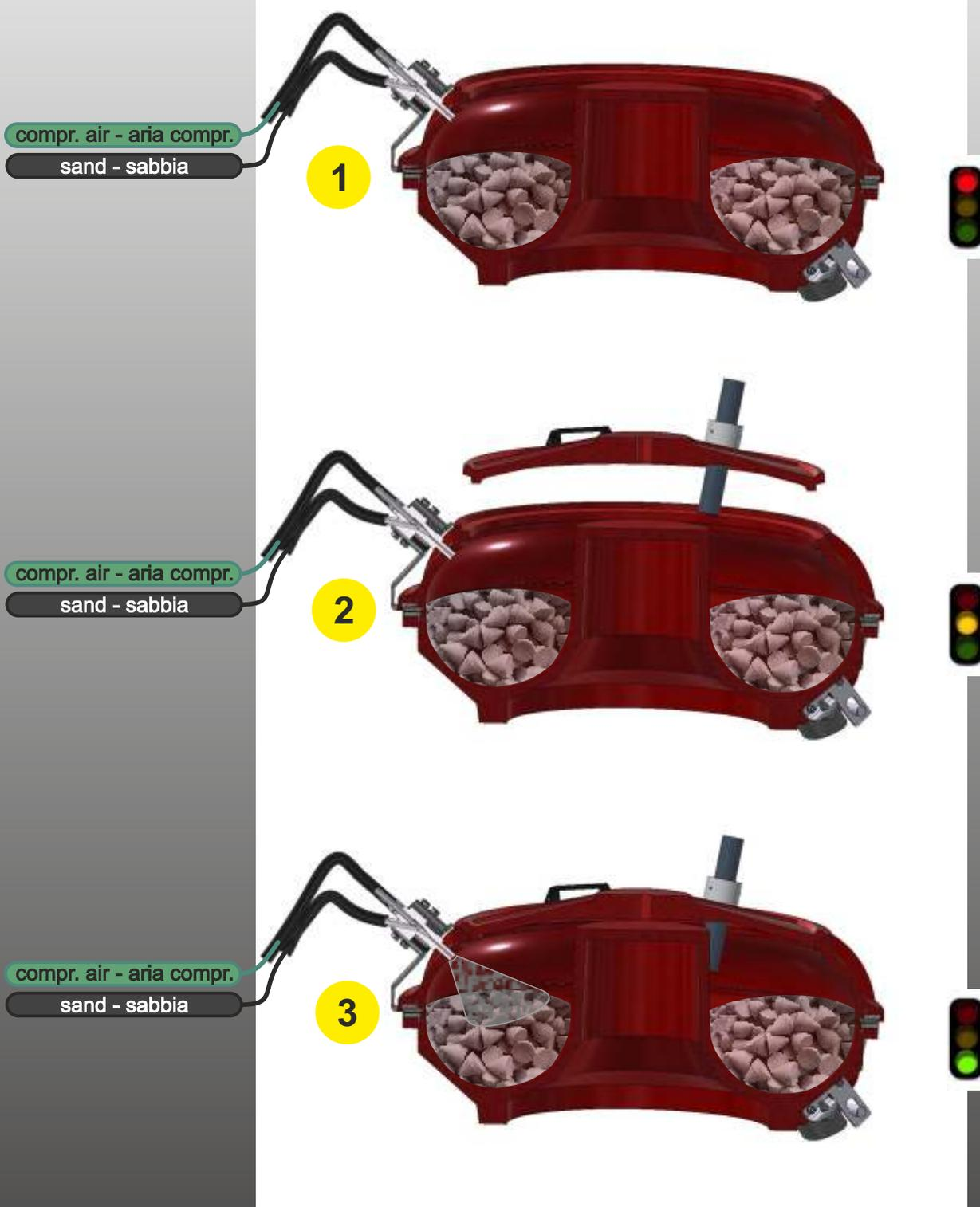
La dinamica operativa con le macchine VibroBLAST-VBA-DP - a depressione - è piuttosto semplice:
