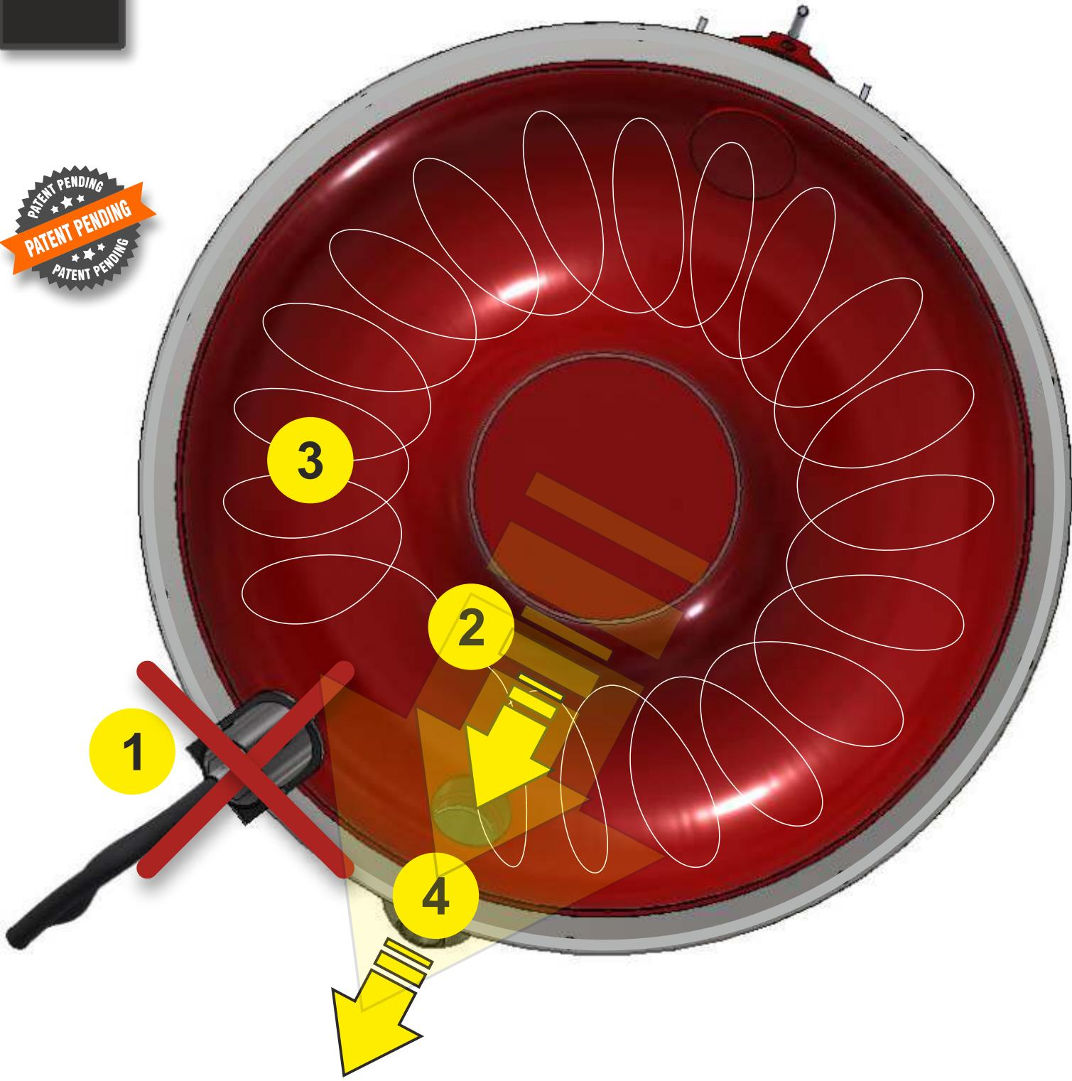
La vraie force du procédé VibroBLAST réside dans les mèdias élastiques qui soutiennent, véhiculent et protègent les composants soumis au procédé de finition, des chocs excessifs.
