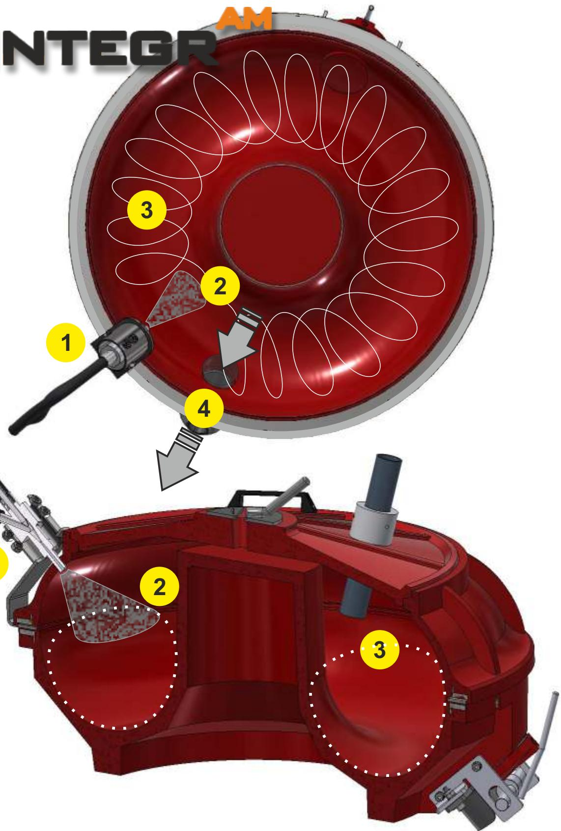
Tous les systèmes VibroBLAST Air DP ont la buse de sablage SN (Side Nozzle - buse latérale) placée dans la zone supérieure de la corolle, pour impliquer les pièces traités par le haut, pendant qu'ils tournent en trois dimensions, dans le sens des aiguilles d'une montre, à l'intérieur du bol de tribo-sablage circulaire.
