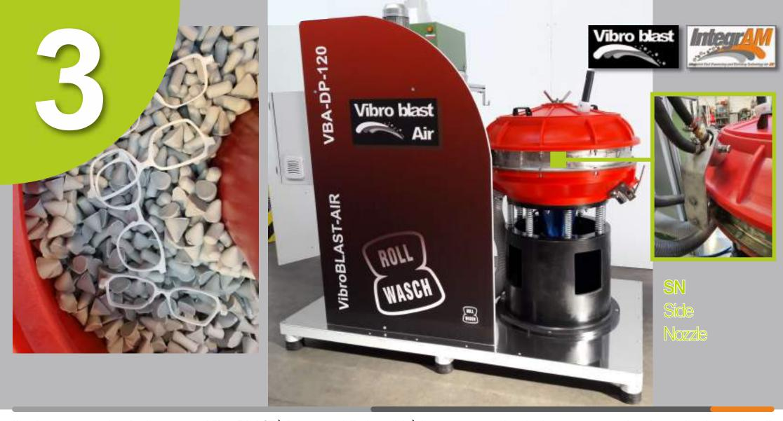
Una ulteriore ragione di scelta di un processo **VibroBLAST** è determinata dalla disponibilità di una gamma completa di soluzioni senza precedenti. Le macchine hanno gli ugelli di sabbiatura sulla corolla -SN (Side Nozzle).
